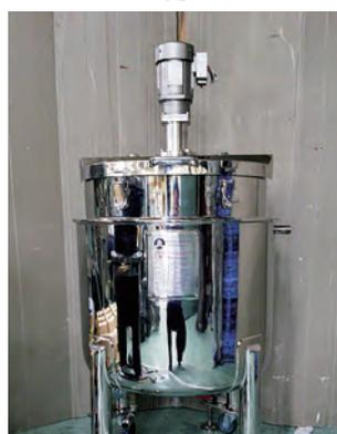
タンク外側がジャケット仕様。冷水又は温水を通し内容液の温度を調整。温度計等の付属品も取付可能（オプション）
