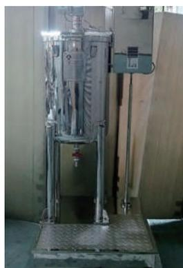
攪拌機付タンクで内容液を混合、溶解。右側に設置の自動供給機を設定することで、人が居なくても液体投入が可能。
