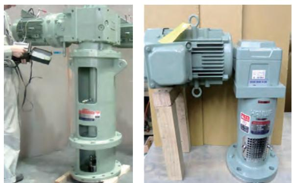
直交軸タイプの減速機を使用し高さを抑えた構造も対応可能です。天井までのスペースに制限があり、据付やメンテナンススペースを考慮しなければならない場合も設計検討致します。
