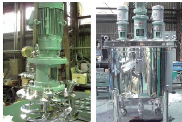
HLT型タンクと攪拌機をセットで製作しました。生産や実験用として幅広い業界のユーザー様にご支持いただいています。
