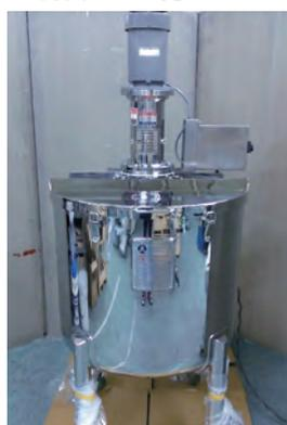
タンク上部にインバータBOXを設置したタンク。実際に攪拌機状況を確認しながら、回転数の調整が可能。設置場所は希望により変更可能。
