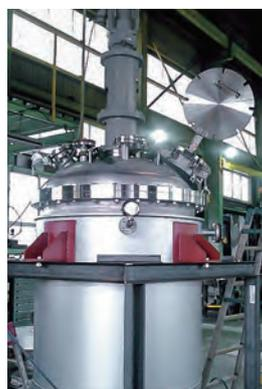
タンク内に圧力をかけ、内容液を攪拌。攪拌機も内部の気体が漏れださないように、メカニカルシールで対応（減圧タンクも対応可能）
