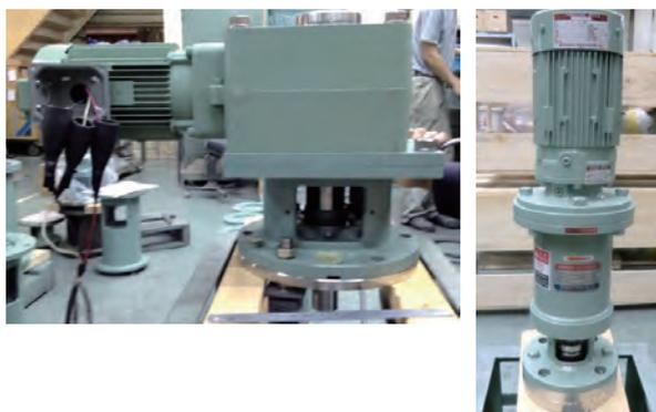
既設タンク取付座に合わせて小型本体を製作しました。近年は多品種少量生産を行っているユーザー様も多く、小型タンクにフィットする攪拌機もご提供しています。
