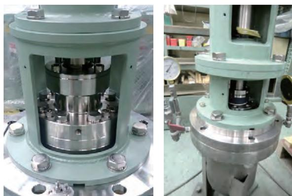
コンタミ防止や缶内からの漏洩が許されない仕様はメカニカルシールを使用します。用途に応じ最適な各種メカニカルシールを選定致します。
