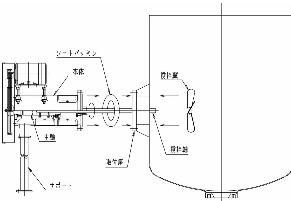
(3) 攪拌軸の振れの確認
